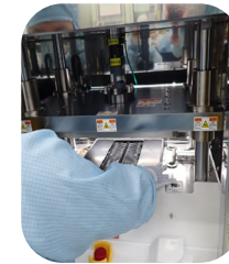
▲【優化後】藉由電動缸膠條壓合機自動壓合
